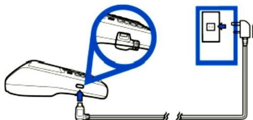
Το τερματικό eray mobile POS συνοδεύεται από καλώδιο τροφοδοσίας το οποίο χρησιμοποιείται για τη φόρτιση της μπαταρίας αλλά και ως εναλλακτική παροχή ρεύματος σε περίπτωση βλάβης της μπαταρίας.
